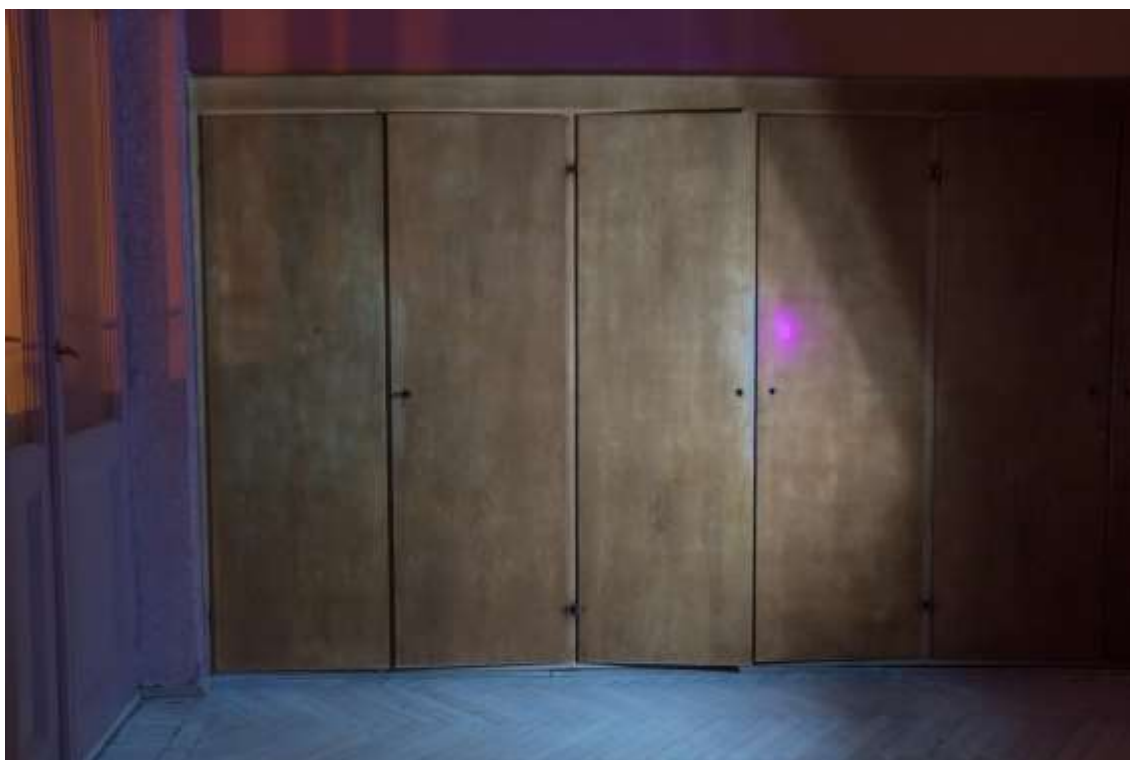
Dílec č. 1 a 2 pod UV světlem, modrošedá fluorescence u míst se setřenou povrchovou úpravou
